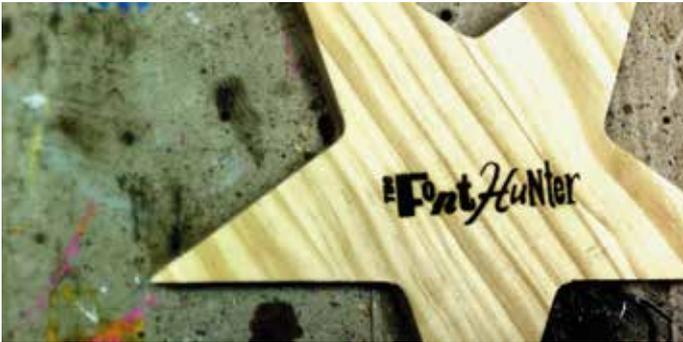
Los sellos por termo grabado son sellos metálicos que se utilizan para marcar madera, cuero y otros materiales a través del calor. Se componen de una placa grabada con el logo o la información a marcar, la maquina eléctrica o empuñadura manual y en algunos casos se acompañan de un regulador de potencia para no dañar los materiales a marcar.
